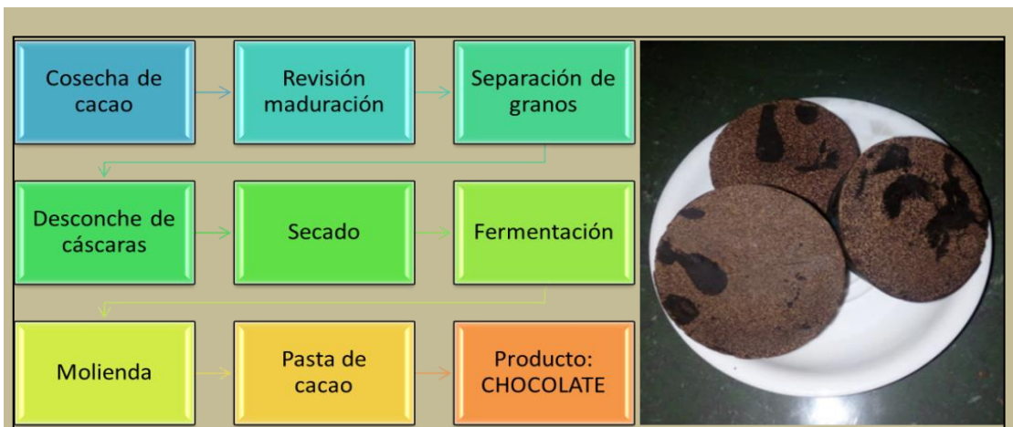
Gráfico 26. Diagrama sobre el procesamiento del cacao artesanal. Elaboración propia
