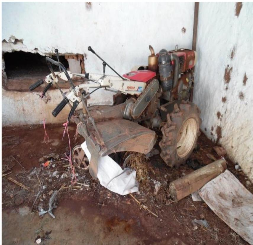
**Figura 21.** Vehículo especial autopropulsado de un solo eje (motocultor) adoptado por Pedro productor empírico para el trabajo superficial del suelo en su unidad de producción.
